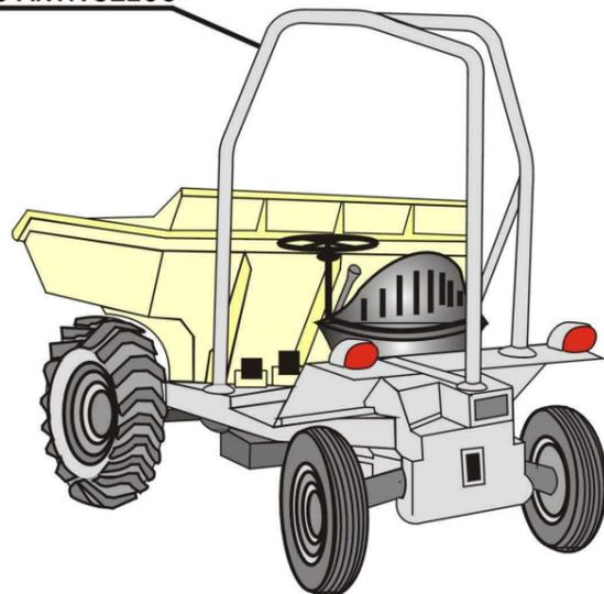
LOS VEHICULOS QUE NO TENGAN CABINAS CUBIERTAS PARA EL CONDUCTOR, DEBERAN SER PROVISTOS DE SEGURIDAD PARA EL CASO DE VUELCO (ART. 124 O.G.S.M.)
