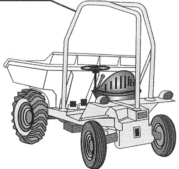
LOS VEHICULOS QUE NO TENGAN CABINAS CUBIERTAS PARA EL CONDUCTOR, DEBERAN SER PROVISTOS DE SEGURIDAD PARA EL CASO DE VUELCO (ART. 124 O.G.S.M.)
