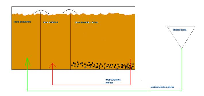
Tras dejar el reactor, el agua pasa al proceso de <u>sedimentación y</u> <u>clarificación</u> que está formado por tres decantadores circulares de 28 m de diámetro y 3,80 de calado.
